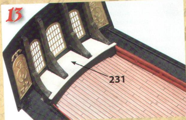
Переходим к каюте капитана: отдели от деревянной рамы, прилагавшейся к этому номеру, помост 231 и попробуй установить его «всухую» между опорами на корме; в случае необходимости, слегка обработай места соединения с помощью мелкозернистого напильника.
