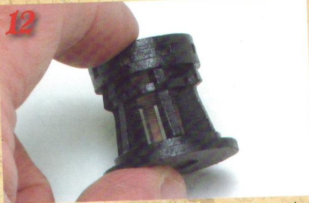
Теперь ты можешь вынуть деревянную ось; отшлифуй поверхности шпилля с помощью мелкозернистой наждачной бумаги; затем покрась шпиль чёрной матовой краской (Humbrol Matt Black 33) или же тёмно-коричневой.
