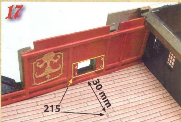
Вставь другие четыре ушка 215 в левую стенку каюты, в отверстия, которые были сделаны в процессе работы над номером 71. Сделай ещё одно отверстие в палубе, примерно в 30мм. от стенки, затем вставь в него ушко 215.
