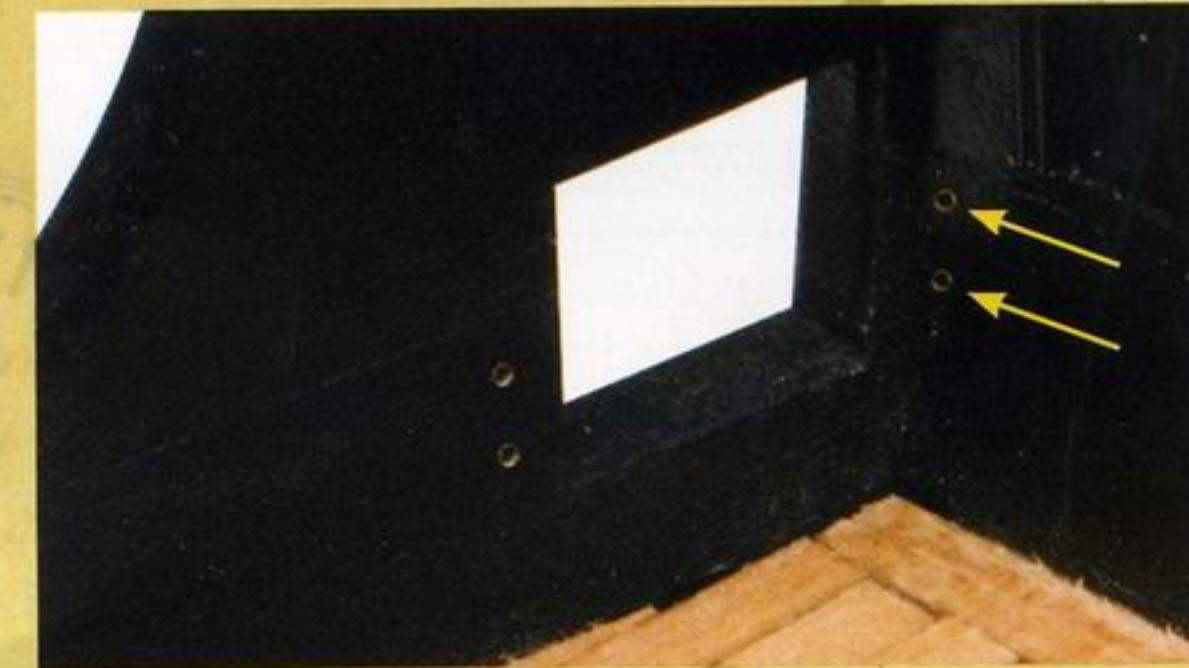
Возвращаемся к левому борту, вставь крючки в отверстия и закрепи их каплей клея, повернув их так, как показано в круговых изображениях. В целом тебе понадобятся 30 крючков для каждой стороны корабля.
