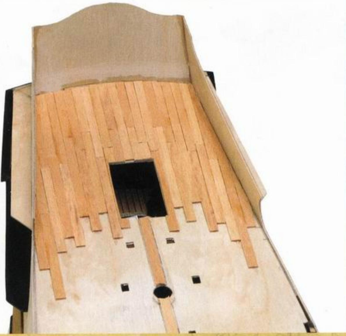
Клади настил на квартердек, не забывай, что рейки не должны закрывать отверстия в палубе. Если отверстие очень маленькое, карандашом сделай отметку на рейке, которая его покрывает, чтобы потом можно было легко найти это место и вырезать нужный фрагмент рейки.
