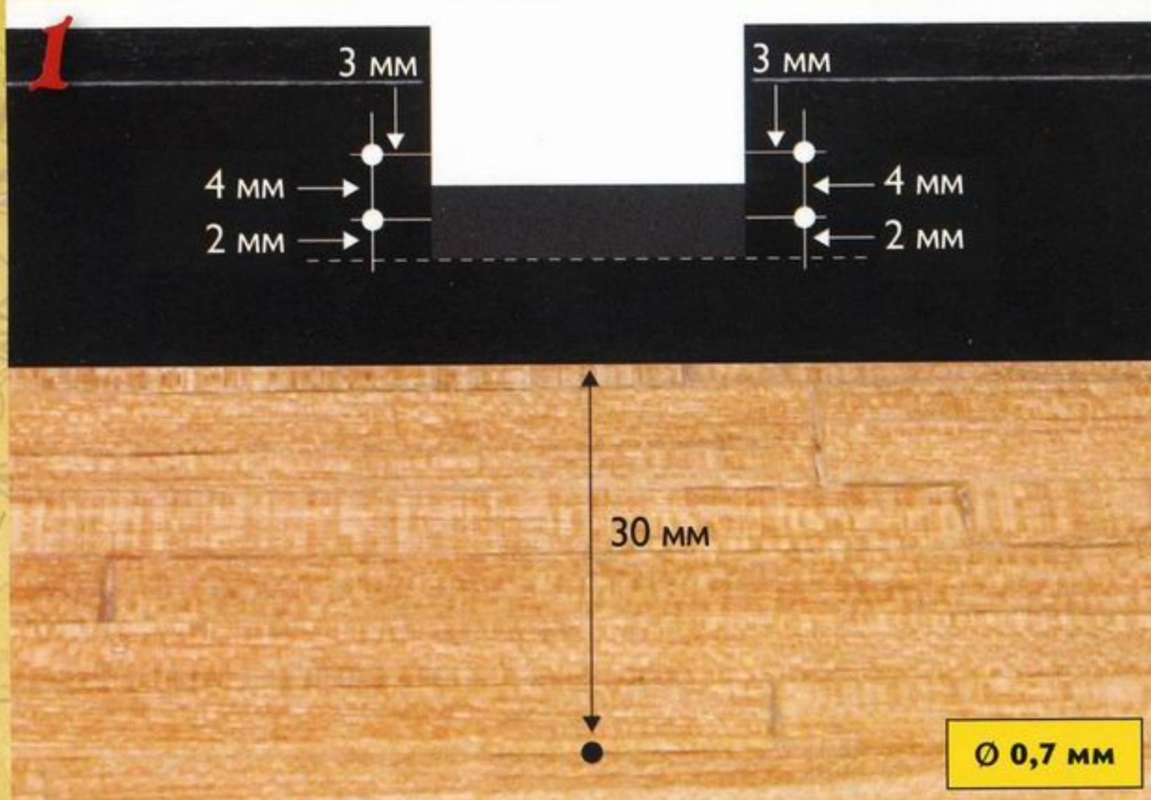
Начинаем с левого борта, сделай по 4 отверстия с помощью сверла по дереву (диаметром 0,7 мм.) по бокам от каждого орудийного порта и одно отверстие в палубе, в соответствии с расположением орудийных портов.
