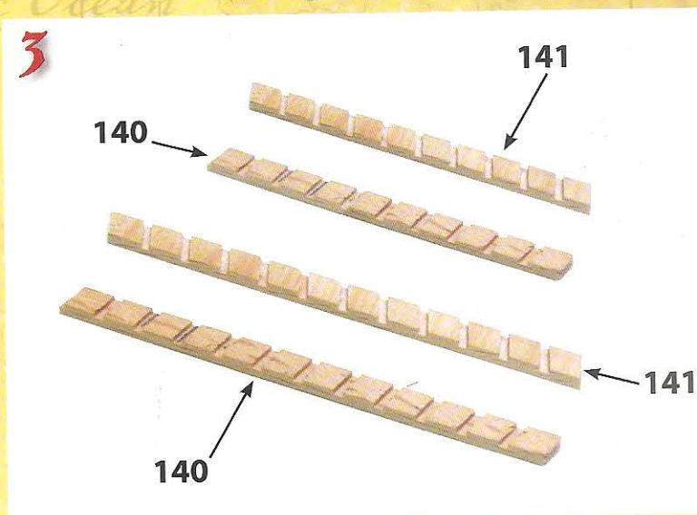
Сейчас у тебя должно быть под рукой две балки с одиннадцатью выемками и две балки с девятью выемками: четыре поручня готовы, на них ты будешь крепить ступеньки!
