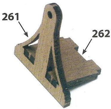
Отдели от рамы две опоры для рулевого колеса 261 и платформу 262. Вставь и приклей платформу 262 в основание первой опоры 261, как показано на рисунке сверху.
