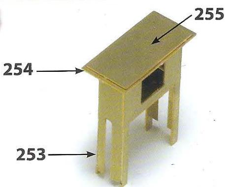
Отдели от латунной рамы основу 254 и приклей её на верхнюю часть корпуса нактоуза. Затем сделай тоже самое с крышкой 255, которую нужно приклеить поверх детали 254.
