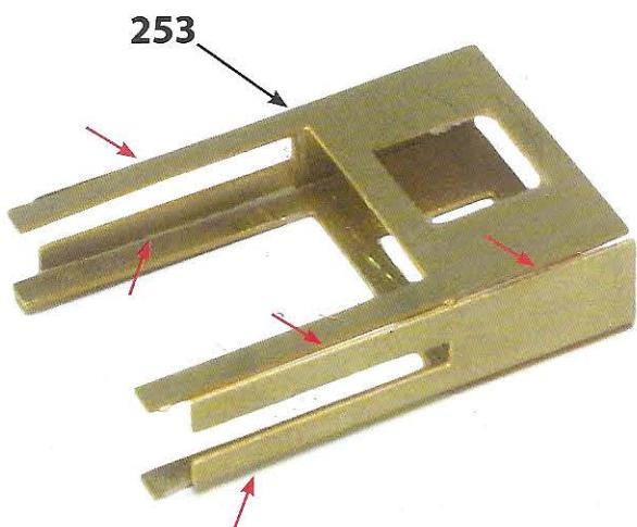
Заверши сгибать корпус нактоуза 253 так, как показано на рисунке сбоку; затем нанеси быстросохнущий цианокрилатный клей вдоль всех линий соединения, на которые указывают красные стрелочки, и оставь деталь сохнуть.
