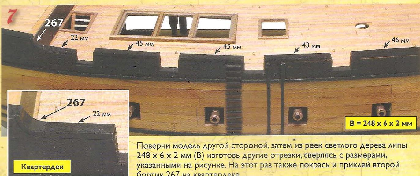
Поверни модель другой стороной, затем из реек светлого дерева липы  $248 \times 6 \times 2$  мм (В) изготовь другие отрезки, сверяясь с размерами, указанными на рисунке. На этот раз также покрась и приклей второй бортик 267 на квартердеке.
