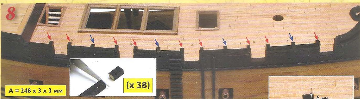
Теперь возьми рейки из светлого дерева  $248 \times 3 \times 3$  мм (А) и покрась их с помощью Humbrol Matt Black 33. Затем изготовь из рейки 38 параллелепипедов длиной 6 мм и приклей первые 13 поверх отрезков, зафиксированных тобой в прошлом пункте. На фотографии красные стрелочки указывают на параллелепипеды, установленные заподлицо с орудийными портами, тогда как синие стрелочки – на те, что находятся в центре. Закрась чёрным цветом места обреза параллелепипедов.
