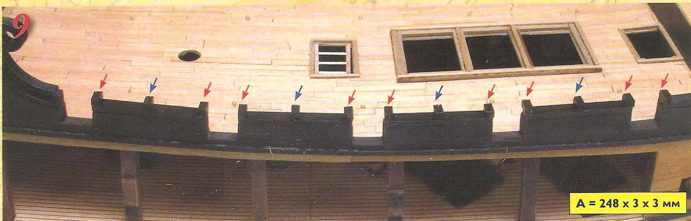
Поверни модель и приклей ещё 13 параллелепипедов, как мы уже делали на левой стороне (по две детали – заподлицо с орудийными
