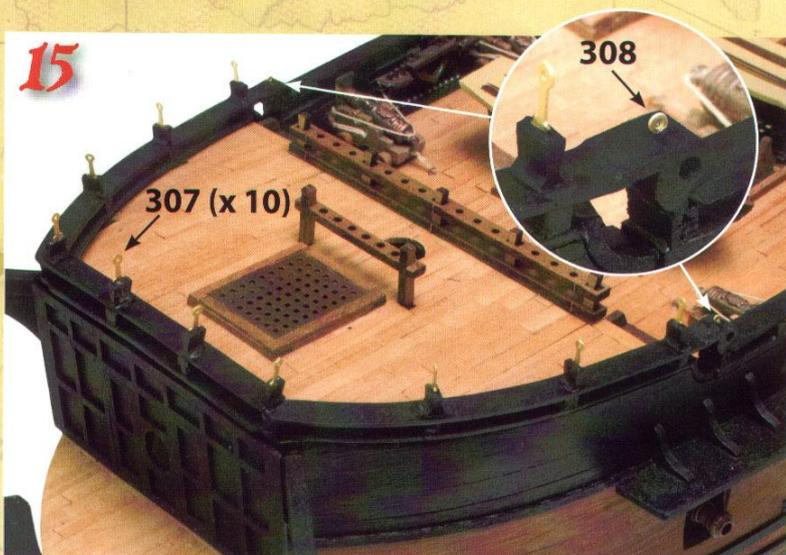
В завершение возьми десять стоек 307 и две 308, сделай отверстия в опорных столбиках (для стоек 307 – диаметром 0,7мм, для стоек 308 – 0,5мм) и вставь в них стойки. Покрась стойки в чёрный цвет, затем протяни нить сквозь отверстия, завяжи узелок на концах нити на уровне стоек 308.
